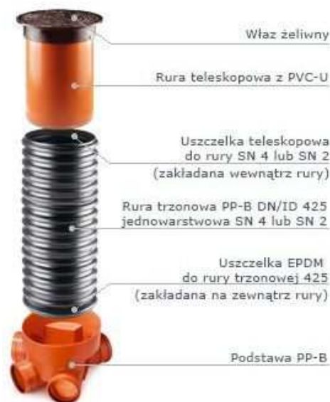
Budowa studzienki DN 425
